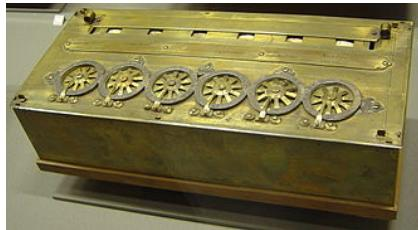
Blaise Pascal conçoit cette machine [1] capable d'additionner et de soustraire deux nombres de façon directe [2]. Elle comprend des inscripteurs (ensemble de roues) permettant de saisir les chiffres des nombres, un mécanisme capable d'additionner avec la propagation de la retenue et un afficheur du résultat.
