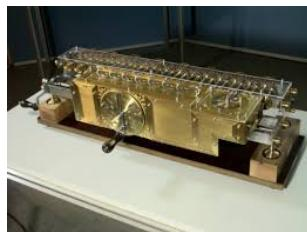
Dans une machine à additionner, le terme que l'on saisit est ajouté au totalisateur, puis il est effacé de l'inscripteur pour faire place au suivant. Dans une multiplication, on doit conserver le multiplicande, le temps de le multiplier successivement par chacun des chiffres du multiplicateur. Leibniz invente cette mémoire mécanique, sous la forme d'un cylindre cannelé, et en juxtapose 8 dans sa machine, autant que de chiffres possibles au multiplicande.
