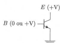
Là encore, cet élément se comporte comme un interrupteur qui laisse passer ou non un courant électrique réalisant les niveaux logiques 1 ou 0. En les combinant, on forme des circuits intégrés mettant ainsi en oeuvre les circuits logiques que nous étudierons ultérieurement.
