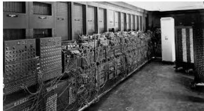
Composé de 18 000 tubes, ce premier ordinateur électronique est programmable à l'aide de fiches, il occupe une surface de 167 m<sup>2</sup> et opère encore en décimal.
