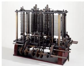
C'est la première machine à calculer **programmable** <sup>[3]</sup>, conçue avec tous les éléments d'un ordinateur actuel, mais seul un prototype inachevé a pu être réalisé.
