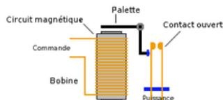
Cet élément se comporte comme un interrupteur qui laisse passer ou non un courant électrique réalisant les niveaux logiques 1 ou 0.
